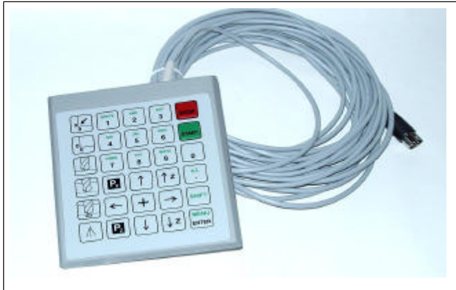
(externes Keypad mit Kabel zum Teachen der Achspositionen direkt an der Maschine)
